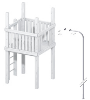
Art. 3107 Feuerwehrstange 169,- Edelstahl, Gesamtlänge: 310 cm, Höhe über dem Boden: circa 230 cm Rohrdurchmesser: Ø 3,4 cm, mit Bodenplatte zur Befestigung im Betonfundament
